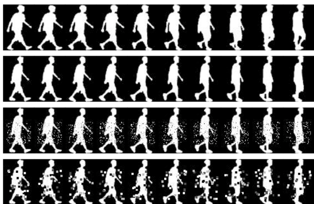
Fig. 6. Schematic of the extended OULP dataset. The first to fourth rows represent ‘Seq00’, ‘Seq01’, ‘Seq02’, and ‘Seq03’, respectively, where ‘Seq02’ and ‘Seq03’ are generated from ‘Seq01’.
